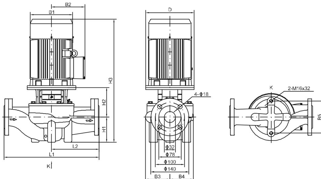
Рисунок 1. Габаритно-присоединительные размеры моделей TD(G)32
