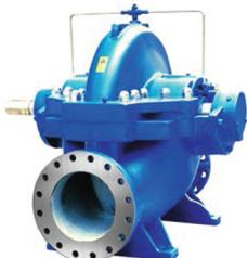
одноступенчатые центробежные электронасосы с рабочим колесом двухстороннего входа и разъемным корпусом, горизонтально или вертикально устанавливаются одноступенчатые электронасосы с корпусом, имеющим продольный разъем, с радиальным рабочим колесом двойного всасывания, присоединительными фланцами на корпусе.
